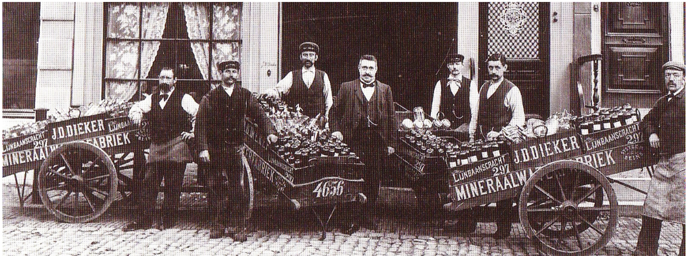
Detail van een foto uit 1898 ter gelegenheid van het 12 ½ jarig bestaan van mineraalwaterfabriek J.D.Dieker in Amsterdam. Bij het laden van de handkarren zijn de zware kratten met sifons vanwege het gewicht boven de as geplaatst zodat de zaak in balans bleef. (Uit Peter Zwaal: Frisdranken in Nederland, Rotterdam 1993).
