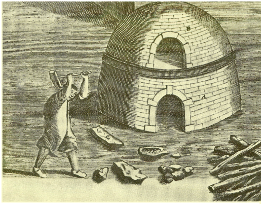
Glasoven uit 1689 met een arbeider die de fritmassa verpulvert. Uit: Kunckel's 'Art Vitraria'. Hieronder: Het fundament van de 17 e eeuwse fritoven. De brede muur was de achtergevel van het glashuis.
