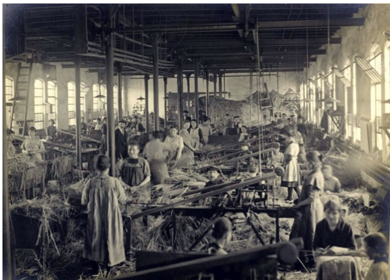
Boven: Exportbierflessen worden voorzien van strohulzen. Een beeld van de verpakkingslijn bij de Amstel brouwerij, 1930.
