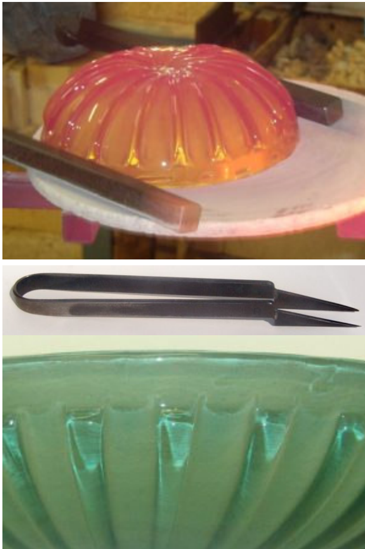
Boven en vorige pagina: Productiefoto's van Taylor en Hills's methode om ribschalen te maken. Overgenomen van de website romanglassmakers.co.uk
