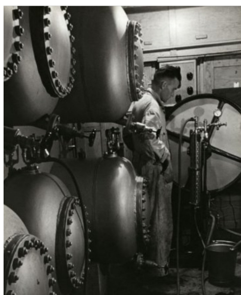
Twee foto's gemaakt in het Laboratorium voor Tuinbouwplantenteelt in Wageningen (1935); Het kneuzen van vruchten en de opslag in roestvrij stalen vaten onder koolzuurdruk.
