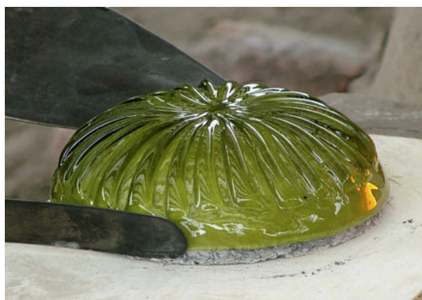
Productiefoto's van Taylor en Hills's methode om ribschalen te maken.
